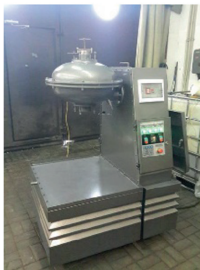
Рис. 2. Загальний вигляд апарату вихрового шару феромагнітних частинок [5]
